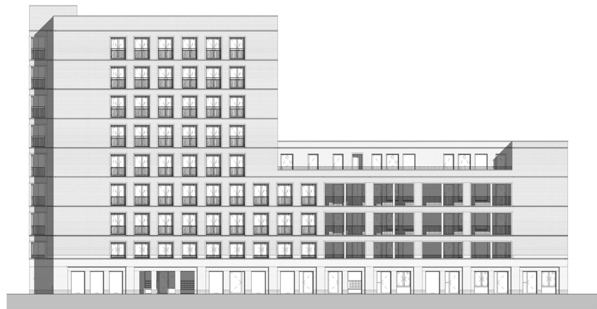
Zuidblok voorgevel schaal 1 : 200
