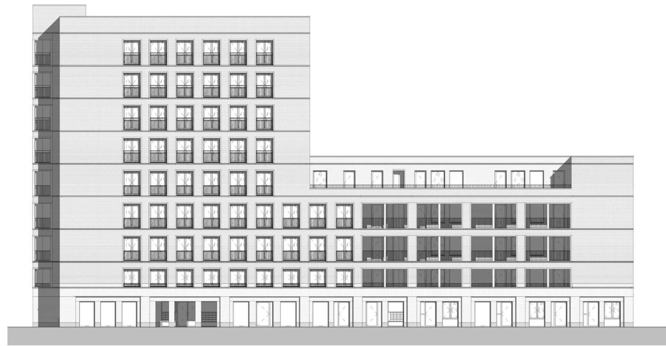
Zuidblok voorgevel schaal 1 : 200
